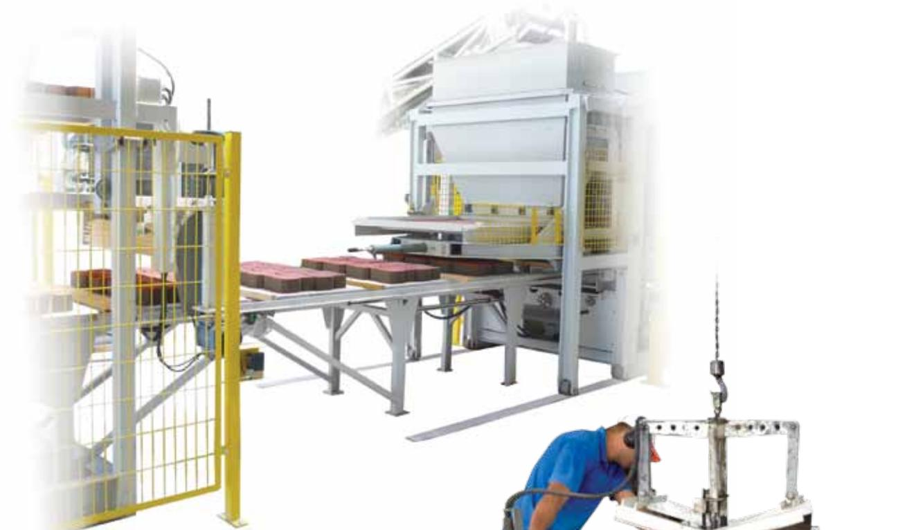
Trata-se da mesma prensa PRIMA, mas com uma maior automatização, acrescentando um conjunto ascensor – descensor que facilita o processo de locomoção das bandejas para a área de cura dos produtos e uma pinça para a paletização final das peças.
