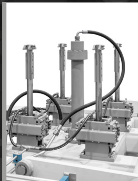
Freios para bloquear o pisador durante a desmoldagem.
