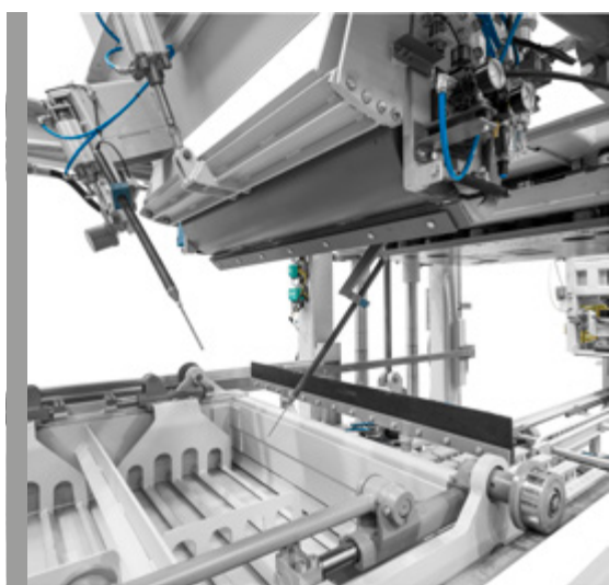
Sistema de enchimento com precisão projetado por Poyatos. Controle da gaveta de alimentação por Encoder.
