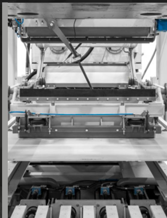
Elevação do marco flutuante em sua marcha à ré para fabricar pisos de grande tamanho.
