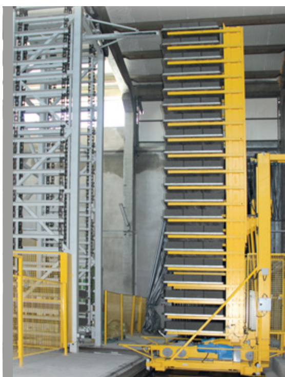
Multiforca com tração total para maior velocidade de funcionamento.
