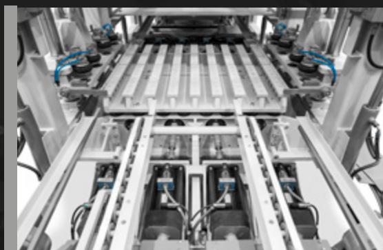
2 mesas de vibração independentes em série para melhor compensação no enchimento. Lubrificação em banho contínuo de óleo para mínima manutenção.
