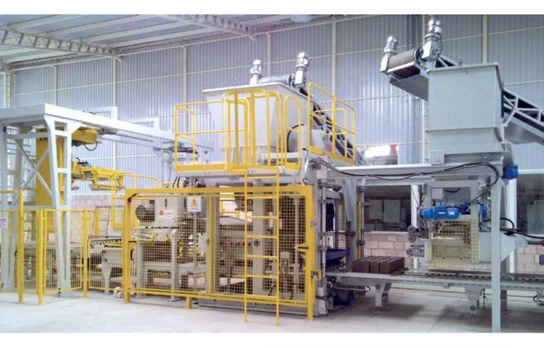
A prensa modelo SYNCRO trabalha com bandejas de madeira ou metálica, com as seguintes medidas: Largura de 1200 mm. até 1400 mm. Comprimento de 600 mm. até 900 mm.
