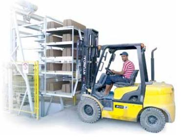
O circuito da instalação pode ser fabricado em linha ou em U, com um conjunto de ascensor e descensor de 5 alturas que agiliza o translado das bandejas até as estufas através de uma empilhadeira. Com relação ao paletizado pode ser com paletizador pneumático, ou automático eletrônico.
